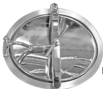
Cadre plat & embouti **CALANDRABLES** à la demande pour épouser parfaitement des galbes de cuves à partir de diamètre 1400 mm. Le cadre se rapporte par l'extérieur, simplifiant ainsi les opérations de découpe, et assure une asepticité par absence de zone de rétention à l'intérieur de la virole.
