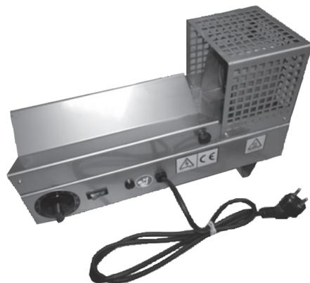
Capsuleuse thermique électrique avec thermostat
