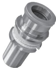
Filetage mâle **GAS** cylindrique sur 70 mm, avec rondelle d'appui soudée, écrou inox et joints EPDM blanc
