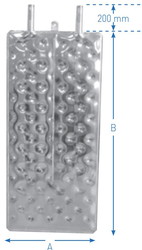
L'échangeur drapeau plan TRANSFLUID permet, grâce à ses nids d'abeilles, de maîtriser la vitesse de circulation du fluide (eau glacée, froide ou chaude) quel que soit le nombre d'échangeurs en demande sur l'installation.
